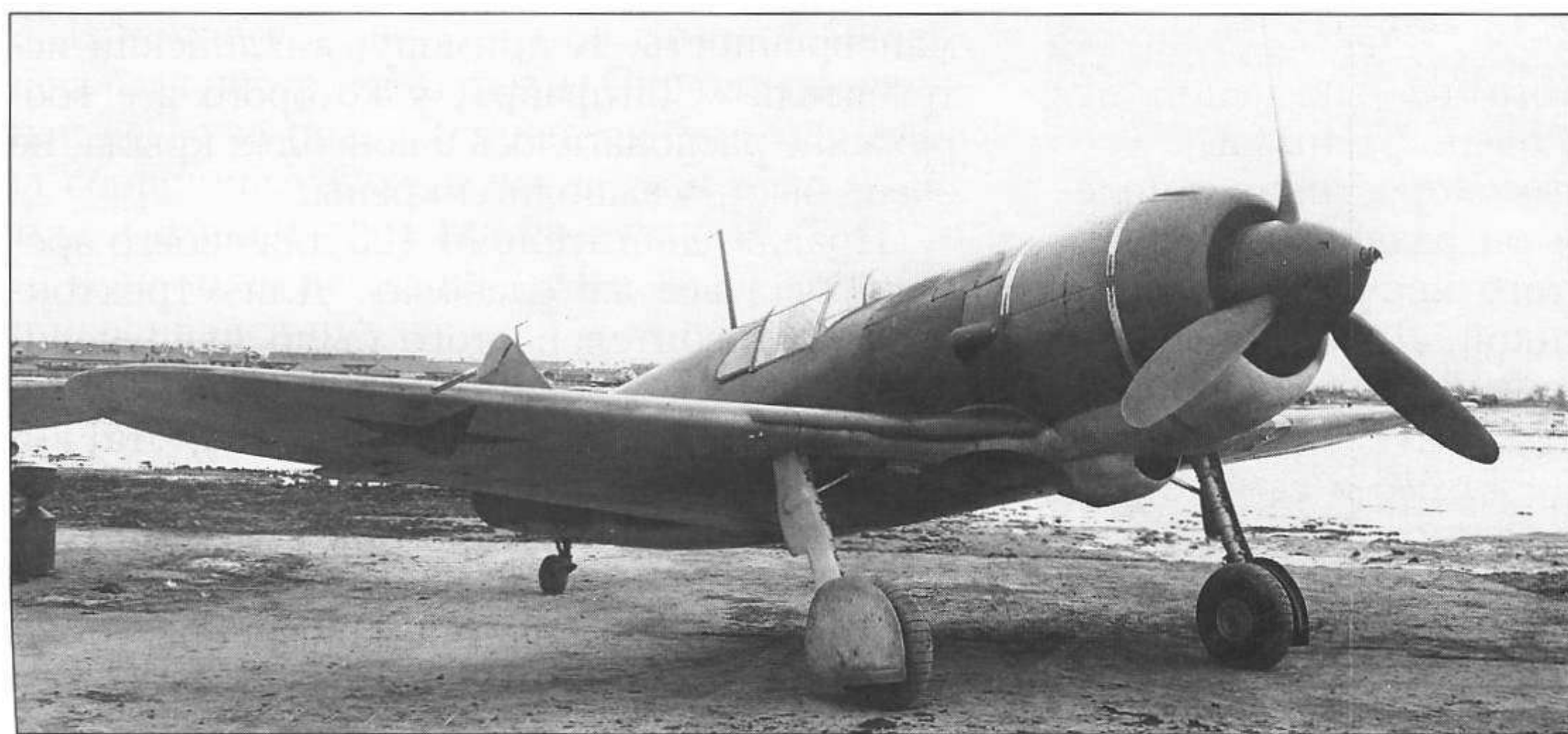
ЛаГГ-3, переделанный под мотор воздушного охлаждения М-82 — прототип Ла-5
