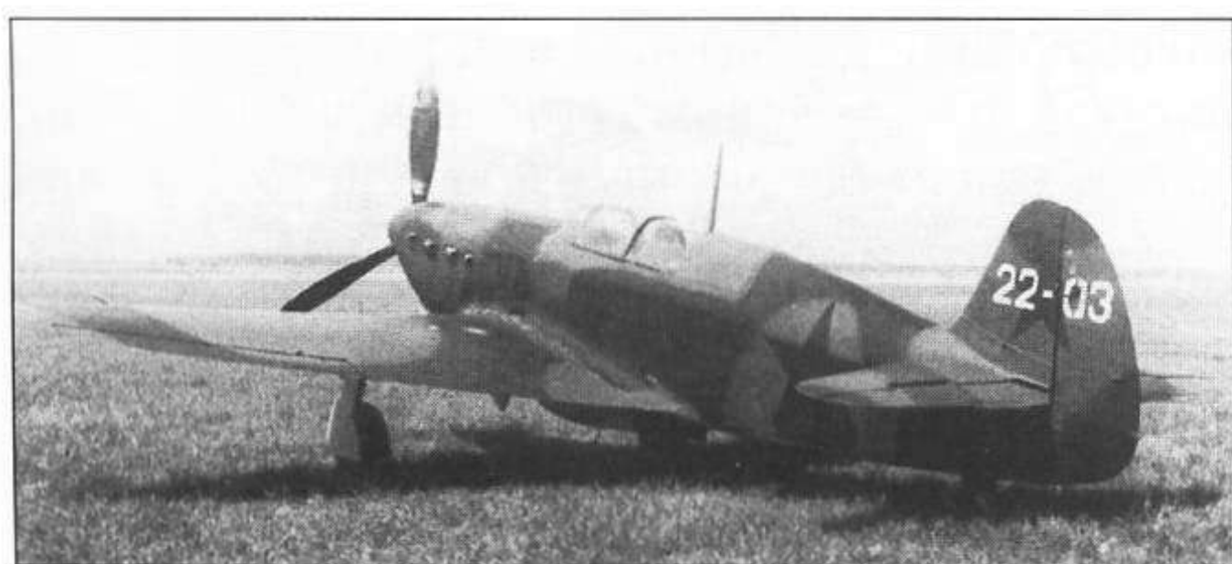
На Як-7Б оборудование задней кабины демонтировали и зашили фонарь фанерой
